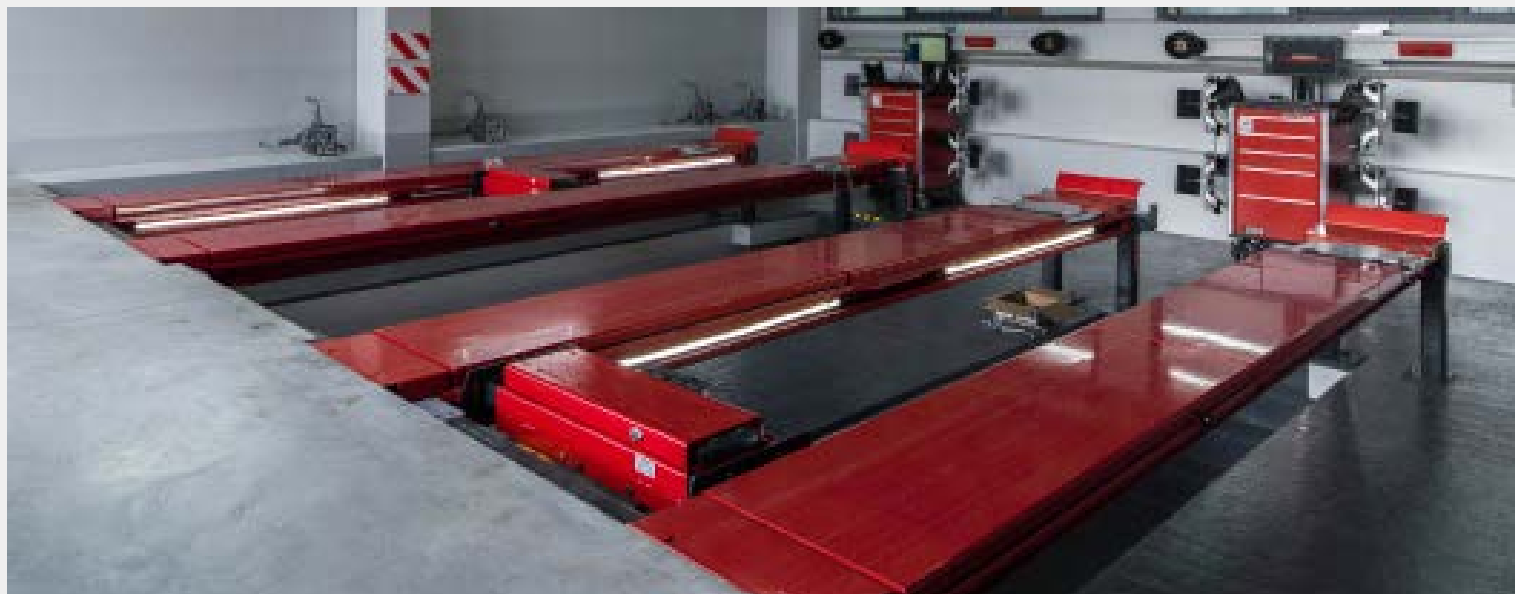
John Bean 3D → zone de géométrie en combinaison avec une fosse de travail Version avec chemins de roulement de longueur moyenne → pour voitures Version avec chemins de roulement longs → pour camionnettes
