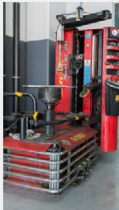
Corghi Master 26 ► → démonte-pneus du type sans levier → pour traiter tout type de pneus / jantes
