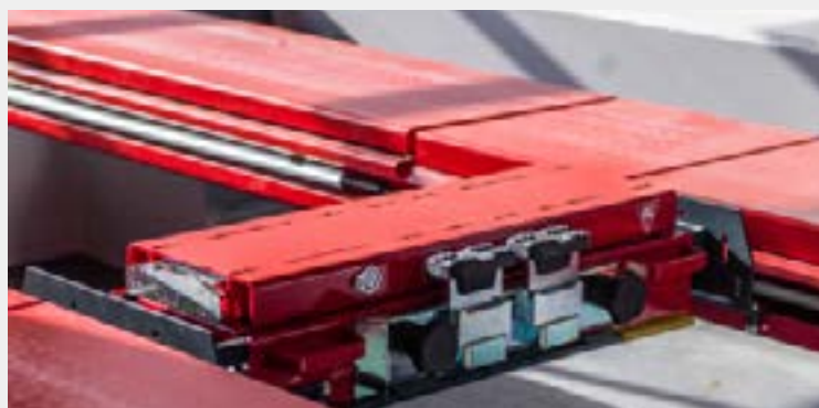
▲ AC → cric pneumatique → chemins de roulement équipés d'un éclairage LED
