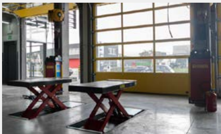
Corghi Erco → 4 ponts service pneus → 3 T → électrohydrauliques
