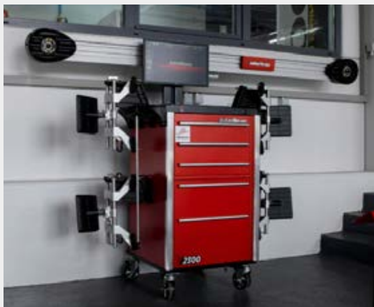
John Bean 3D → zone de géométrie en combinaison avec une fosse de travail Version avec chemins de roulement de longueur moyenne → pour voitures Version avec chemins de roulement longs → pour camionnettes
